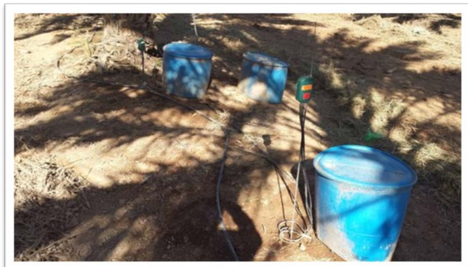
תמונה 3 : הצבת תחנות של טנסיומטרים בטיפול של ההשקיה לפי טנסיומטרים
